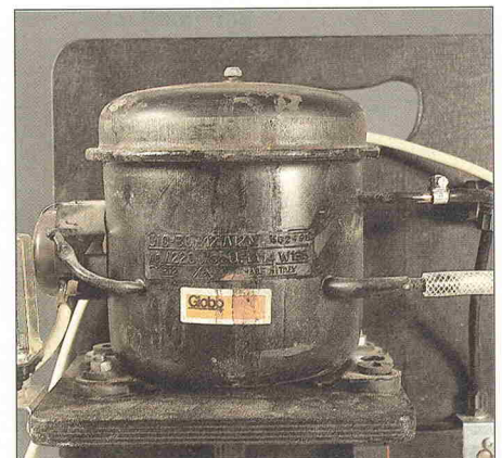
Sperrmüll-Kompressor. Besonders gut erkennt man hier das verschlossene Öleinfüllrohr des 'Findlings'.
